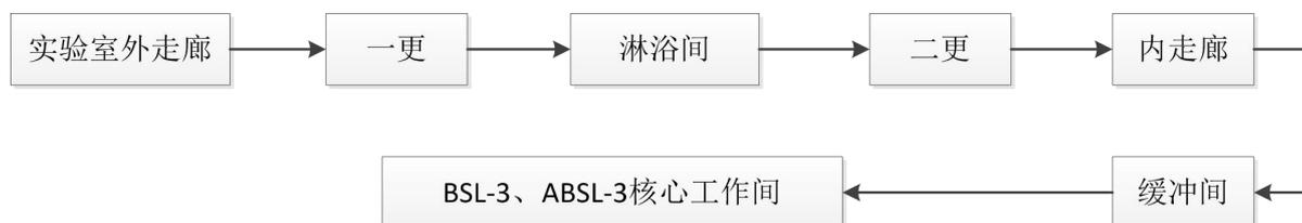
图 2.6-2 生物安全三级实验室气压梯度
