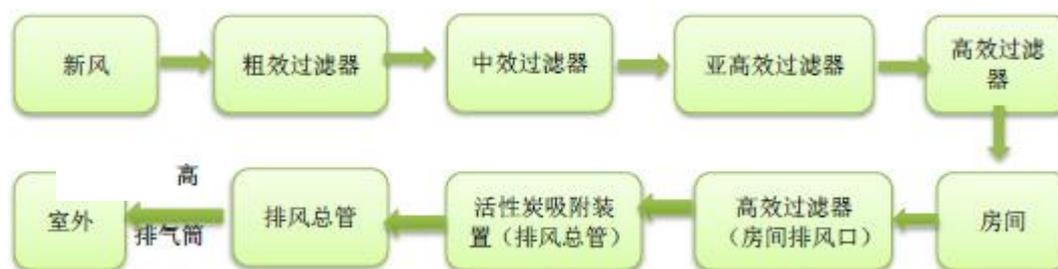
图 6.1-1 生物安全三级实验室空气净化处理过程示意图
